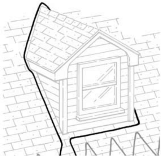
Figure 7. Parcours du câble autour d'une lucarne
